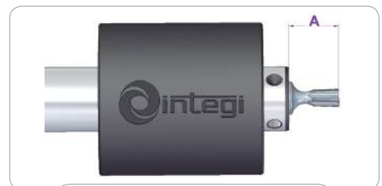
Posición del punzón. Cota "A" Internal broach position. "A" size
